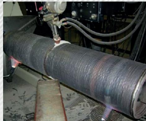
**Наша компания использует технологический процесс, позволяющий выполнить восстановительный ремонт путем нанесения специально подобранный проволоки на изношенные поверхности деталей. Данная технология позволяет увеличить срок службы восстановленного изделия по сравнению с традиционными методами наплавки. При этом стоимость ремонта не будет превышать 60-80 % стоимости нового изделия.**
