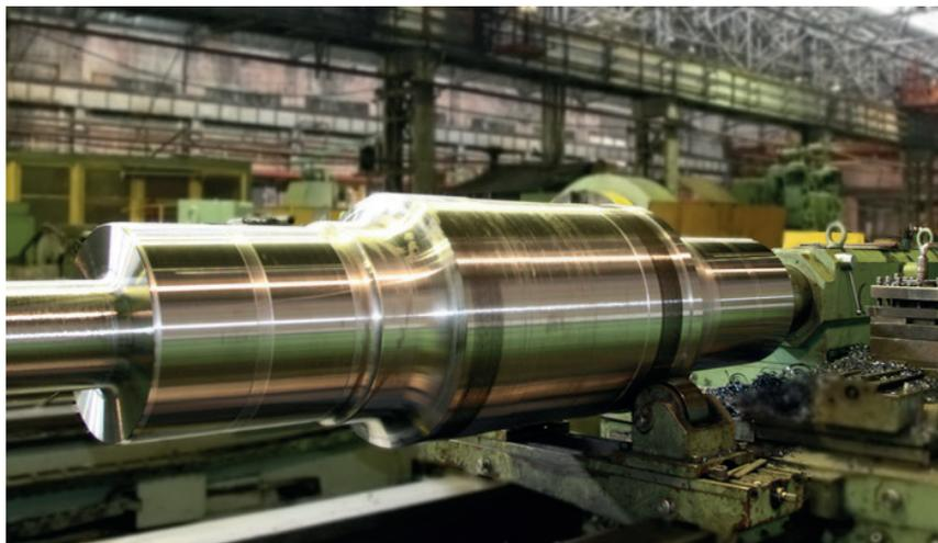
Наплавочные материалы с повышенной коррозионной стойкостью могут наноситься на ролики кристаллизатора для продления срока их службы. Для снижения износа приводных роликов они наплавляются материалами с повышенной абразивной стойкостью.
